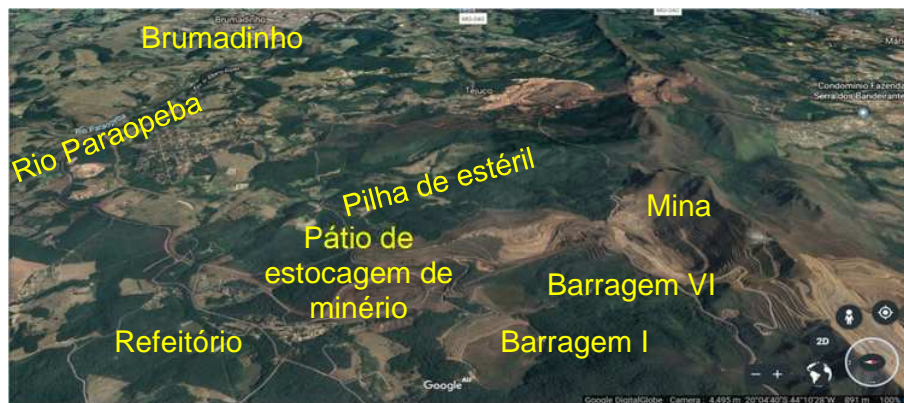
Figura 2: Panorama da Mina do Córrego do Feijão, com vista para oeste (fonte: Google Earth 3d, imagem de 7 de julho de 2018) (texto acrescentado pelos autores)
